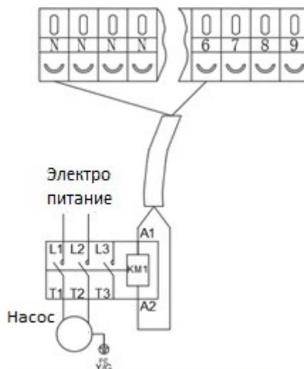
Насос с использованием солнечной энергии в качестве источника тепла
